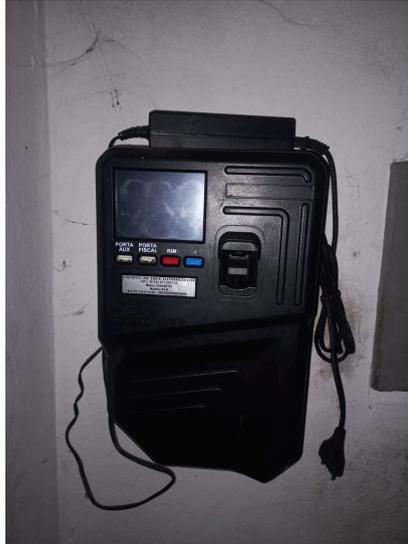
Um relógio ponto eletrônico, marca Circuitec, modelo PontoAll G3
